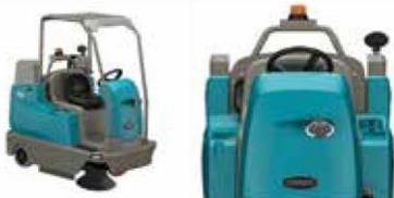
Erhöhen Sie die Sicherheit mit einem optionalen **FOPS-zertifizierten Fahrerschutzdach und Blaulicht** für die Annäherungswarnung.
