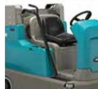
Reinigen Sie Gänge und enge Räume mit dem praktischen optionalen **Handabsaugerschlauch**.
