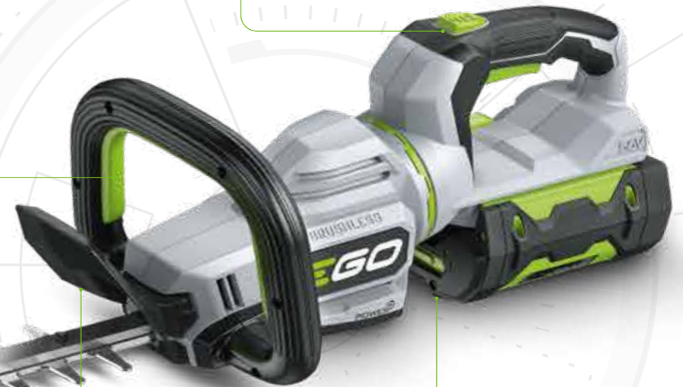
ELEKTRISCHE SICHERHEITSBREMSE Stoppt das Messer sofort, wenn der Griff losgelassen wird
