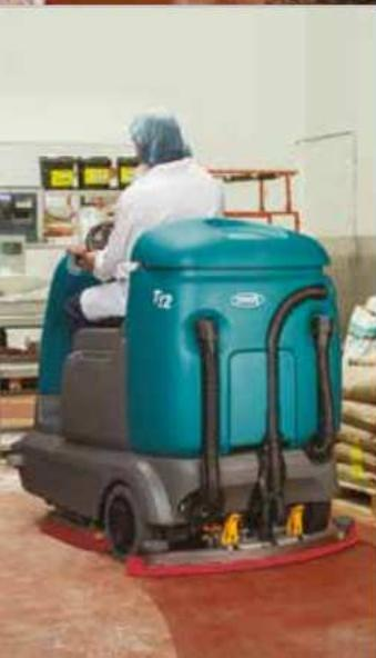
Kunden, die unsere Technologie täglich zur Reinigung ihrer Bodenflächen einsetzen, haben festgestellt, dass sie dadurch insgesamt weniger Wasser, Chemikalien und Verpackungsmaterial benötigen. Die mit den Reinigungsarbeiten verbundenen Umwelteinwirkungen werden verringert. Beim eingeschalteten ec-H2O\*-Betriebsmodus kann die Wassersparnis bis zu 70 % im Vergleich zur herkömmlichen Reinigungsmethode betragen.
